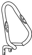
Handläufe mit Pulsplatten
